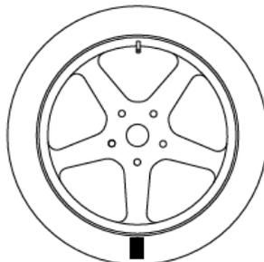
Рис. 5.6 Маркировка шины на 180° относительно клапана
